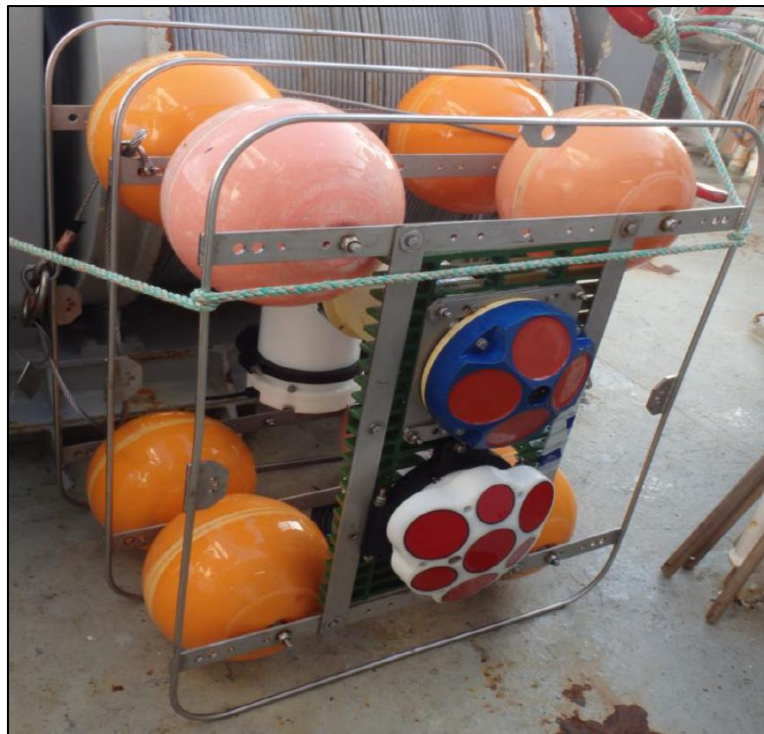
Figure 1: Mise en place des 2 ADCP sur radeau
